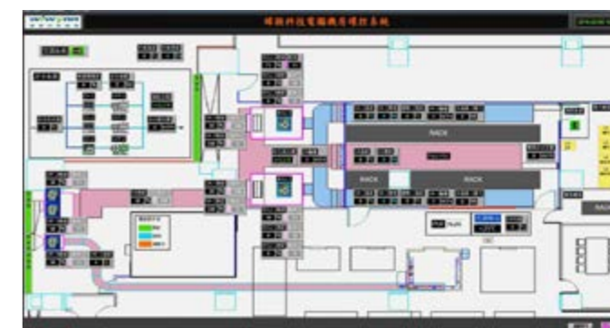
冷通道：自然風混冷氣供應，及風壓、溫、濕度監測
